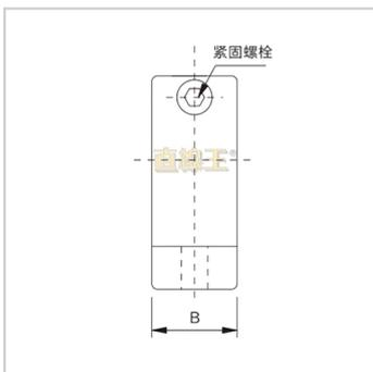
安装螺栓型号 : M5
