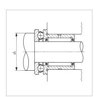
**7/// 附带推力球轴承的滚针轴承 无内圈**NAX、NAX...Z【NAX1023NAX1023Z】--PDF 广东超优轴承有限公司
